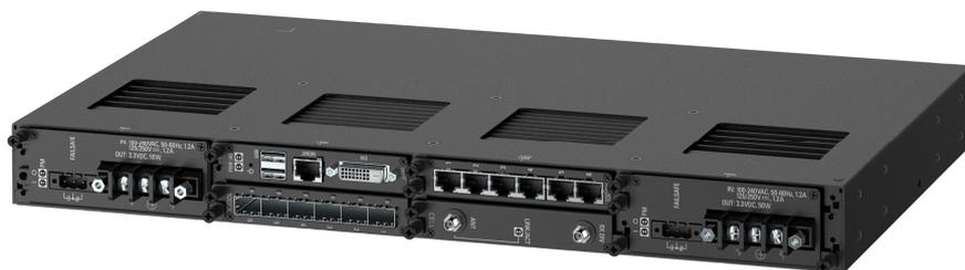
高性价比的RuggedRouter®RX1500/RX1501系列工业加强型. 路由器采用模块化和可现场更换设计平台, 支持WAN、串行和以太网端口供用户选择, 这使其成为电力、工业生产和交通控制系统的理想选择。
